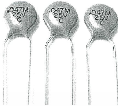
รูปที่ 2.5 โครงสร้างภายนอกของตัวเก็บประจุชนิดงานเซรามิก
