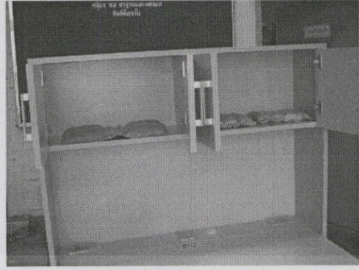
ภาพที่ ค.48 การแอ่นตัวของชั้นวางของ วางน้ำหนักให้กระจายอย่างสม่ำเสมอ 15 นิวตัน/ตร.มม. ที่ไว้เป็นระยะเวลา 7 วัน แล้ววัดการแอ่นตัวสูงสุดของชั้น
