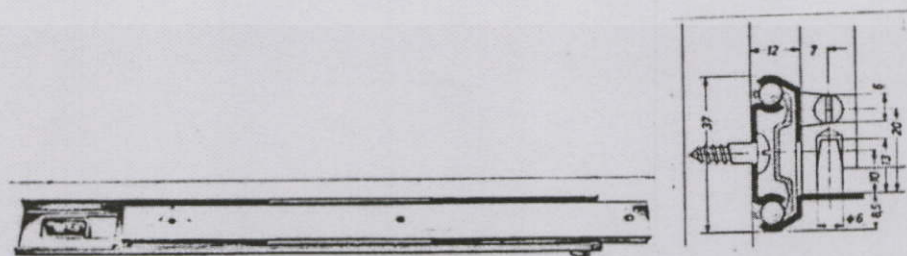
ภาพที่ 2.70 รางลื่นชักระบบลูกปืน รับน้ำหนักได้ 25 กิโลกรัม
