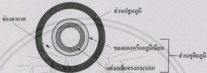
ภาพที่ 2.18 ส่วนทุติยภูมิชนิดอยู่ภายในของมอเตอร์เหนี่ยวนำเชิงเส้นแบบแกนกระบอก
