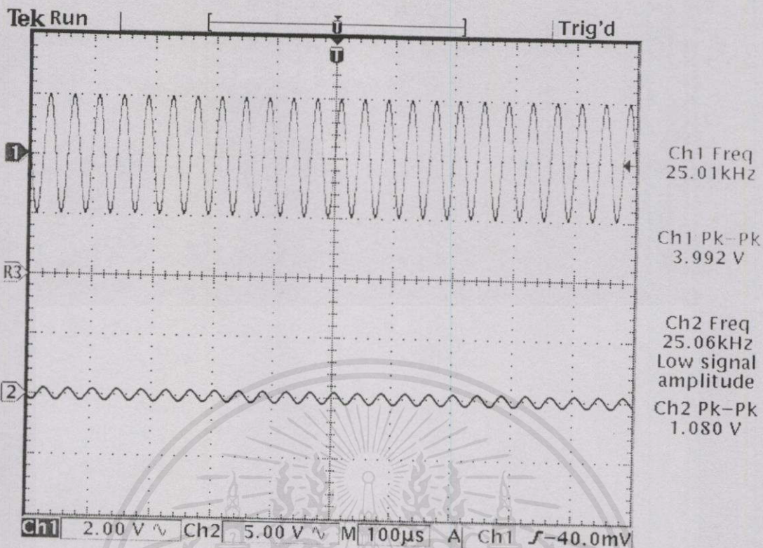
รูปที่ 6.7 แสดงสัญญาณอินพุต (บน) และ สัญญาณเอาต์พุต (ล่าง) ที่ความถี่ 25 kHz
