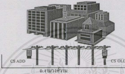
รูปที่ 5.8 แผนภาพแสดงการติดตั้ง CS เพิ่ม
