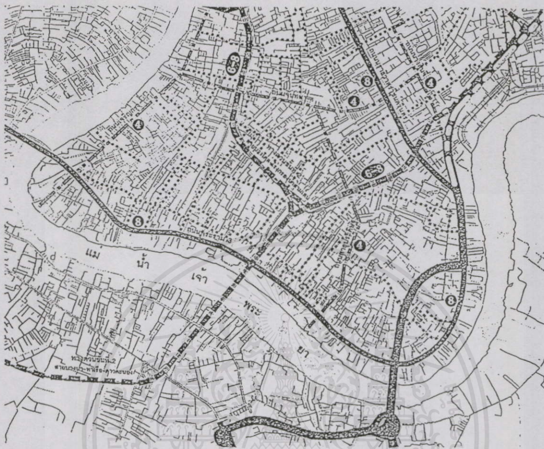
ภาพที่ 4.30 จำนวนช่องจราจรของถนนต่างๆ ในบริเวณพื้นที่โครงการ
