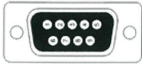
รูปที่ 2.24 การจัดขาของคอนเน็คเตอร์พอร์ตอนุกรมแบบ DB-9 [8]
