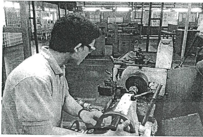
รูปที่ 3.9 แสดงการเจาะปลายเสาเพื่อยึดสกรูทั้งสองด้าน
