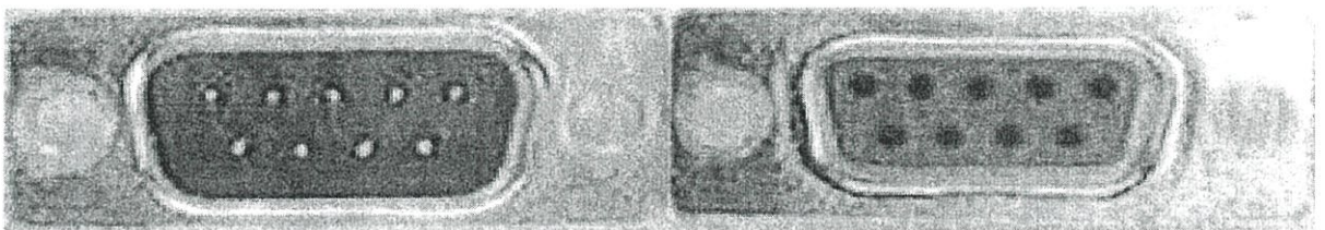
รูปที่ 2.5 ลักษณะของพอร์ตตัวผู้และตัวเมียตามลำดับ
