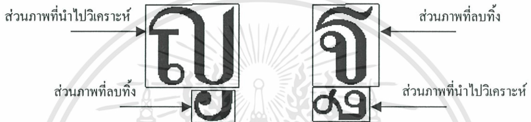
รูปที่ 2.15 ส่วนภาพตัวอักษร “ญ” และ “ฐ” ที่ถูกเลือกไปวิเคราะห์และลบทิ้ง
