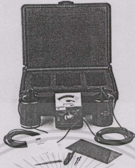
รูปที่ ข-3 เครื่องมือวัดความต้านทานพื้นผิว รุ่น 701 ของบริษัท 3 เอ็ม ประเทศไทย จำกัด
