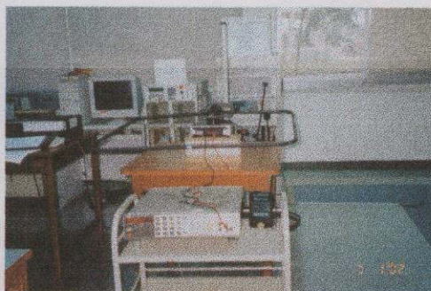
รูปที่ 4.12 การทดสอบผลอันเนื่องมาจาก power magnetic field กับ MET-10VDC-II
