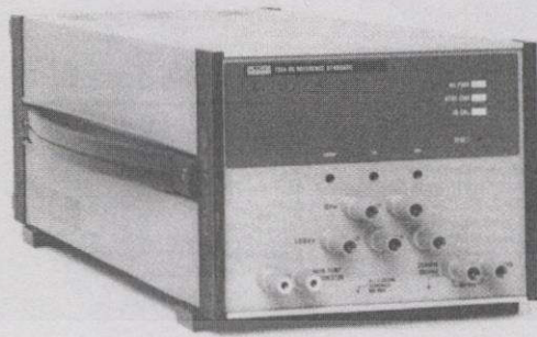
รูปที่ 2.9 ชุดแรงดันไฟฟ้ามาตรฐานขนาด 1, 1.018 และ 10 โวลต์ [5]
