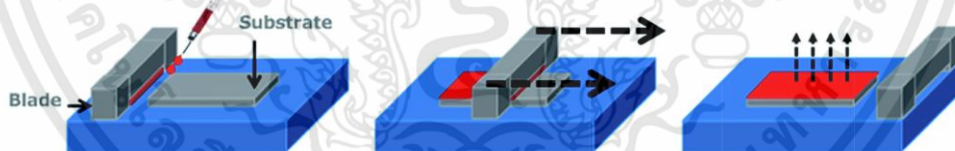
รูปที่ 2.27 ขั้นตอนการเตรียมฟิล์มด้วยเทคนิคปาดเคลือบ [40]
