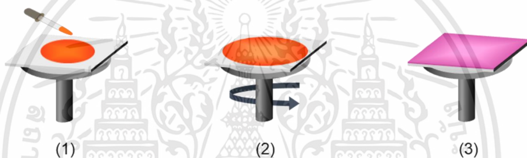
รูปที่ 3.6 ขั้นตอนการเคลือบฟิล์มบาง P3HT ด้วยการหมุนเคลือบ
