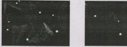
รูปที่ 2 แสดงภาพต้นฉบับ และภาพที่ได้หลังจากผ่านกระบวนการ Scaling into block-base square segmentation ด้วย ขนาดบล็อก 20 x 20 แบ่งกลุ่มได้ 14 บริเวณ
