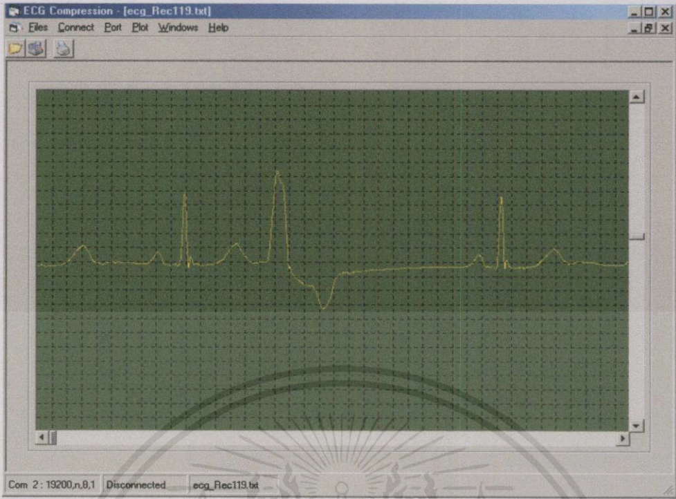
รูปที่ 6.46 แสดงรูปสัญญาณไฟฟ้าหัวใจ Record x119 ที่ผ่านกระบวนการลดขนาดข้อมูลโดยใช้เครื่องบันทึกและบีบอัดสัญญาณไฟฟ้าหัวใจในเวลาจริงบน MCS-51
