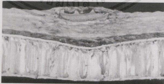
รูปที่ 4.14 การยวบตัวของเซลลั้วรงผึ่ง (.38 Woven 6.35)
