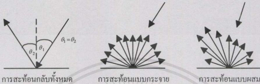
รูปที่ 2.5 เปรียบเทียบปรากฏการณ์การสะท้อนแสงในลักษณะการสะท้อนกลับหมด การสะท้อนแบบกระจาย และการสะท้อนแบบผสม
