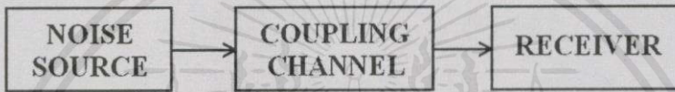
รูปที่ 4.5 บล็อกไดอะแกรมการส่งผ่านสัญญาณรบกวน
