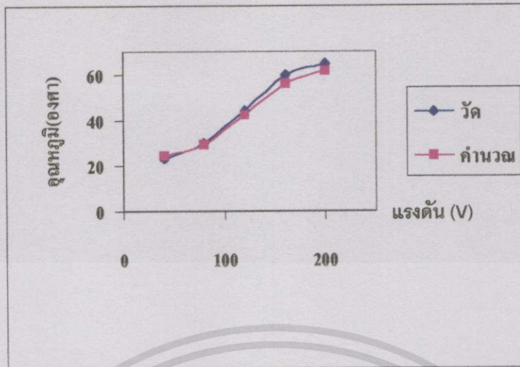
รูปที่ 6.37 กราฟเปรียบเทียบอุนหภูมิที่วัดจริง และคำนวณ ของฉนวน Case B โดยปรับแรงดัน
