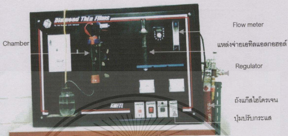
รูปที่ 4.2 ชุดอุปกรณ์การทดลองที่ใช้ในการสังเคราะห์ฟิล์มลิกเพอร์
