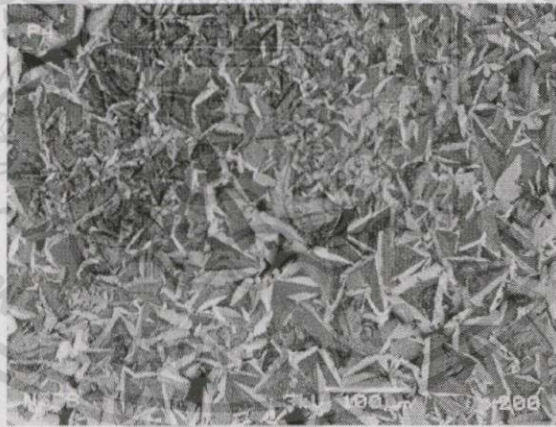
รูปที่ 2.11 ลักษณะของผลึกที่มีความแตกต่างของขนาดจากการใช้หน้ากากป้องกันแต่ใช้เวลาในการสังเคราะห์เป็นเวลานาน
