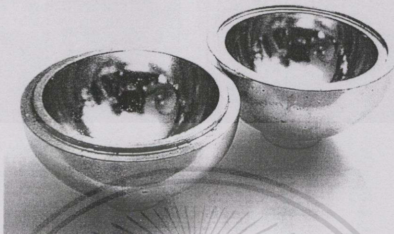
รูปที่ 3.1 ลักษณะของแม่พิมพ์ที่ใช้ในการทดลอง
