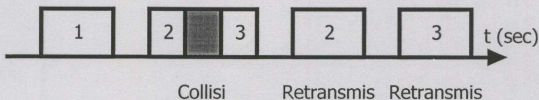
ภาพที่ 3.3 กลไกการชนกันของแพ็กเก็ตในวิธีอะโลฮา
