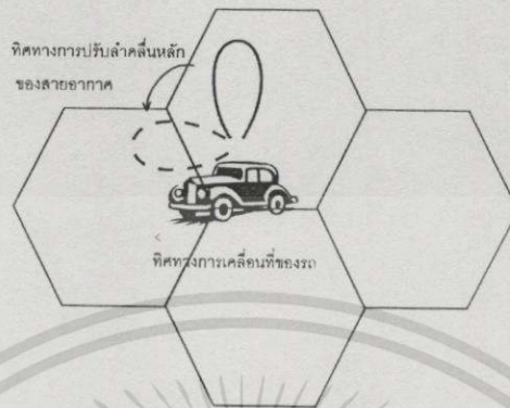
รูปที่ 1.3 การสวิตช์ลำคลื่นของสายอากาศเมื่อพาหนะมีการเคลื่อนที่
