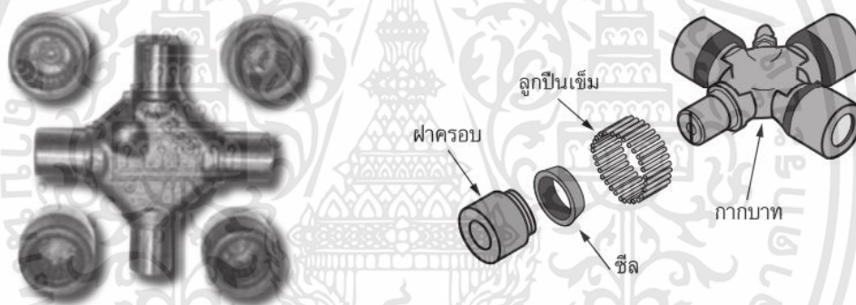
รูปที่ 3.91 ส่วนประกอบของข้อต่ออ่อนหรือยอยต์เพลากลาง (ที่มา : สมปอง คงนึม 2559 : 85)
