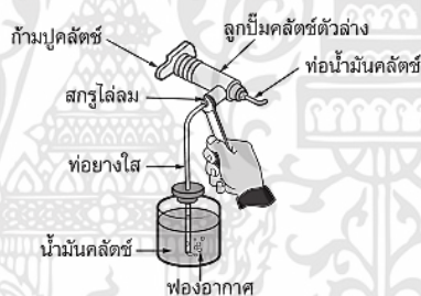
รูปที่ 3.20 เมื่อเปลี่ยนน้ำมันคลัตช์ใหม่จะต้องทำการไล่ลมคลัตช์ทุกครั้ง (ที่มา : สมปอง คงนิม 2559 : 29)
