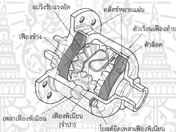
รูปที่ 3.97 เฟืองท้ายแบบลิมิเต็ดสลิปใช้คลัตช์หลายแผ่นจำนวน 2 ชุด
