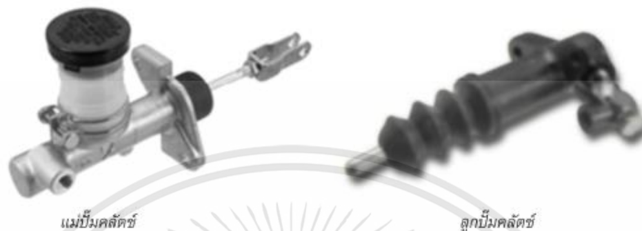
รูปที่ 3.14 แม่ปั๊มคลัตช์และลูกปั๊มคลัตช์ตัวล่าง (ที่มา : สมปอง คงน้อม 2559 : 20)
