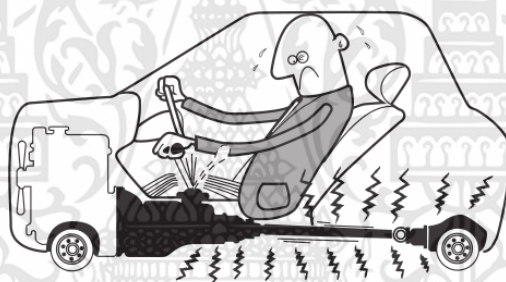
รูปที่ 3.85 มีเสียงดังผิดปกติที่บริเวณเพลากลาง
