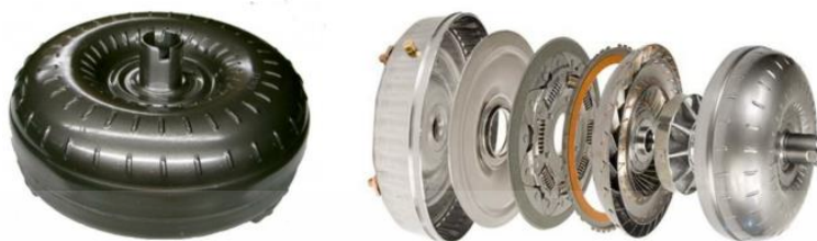
รูปที่ 3.48 รูปร่างของเทอร์โบคอนเวอร์เตอร์และส่วนประกอบภายใน (ที่มา : สมปอง คงน้อม 2559 : 52)
