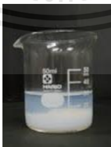
รูปที่ 3.3 ลักษณะของตะกอนที่ได้หลังจากปิดผนึกแล้วทิ้งไว้เป็นเวลา 12 ชั่วโมง
