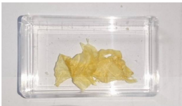
รูปที่ 3.7 วัสดุผสมไฮบริดทินออกไซด์ที่ใช้ท่อนาโนคาร์บอนเป็นแม่แบบ
