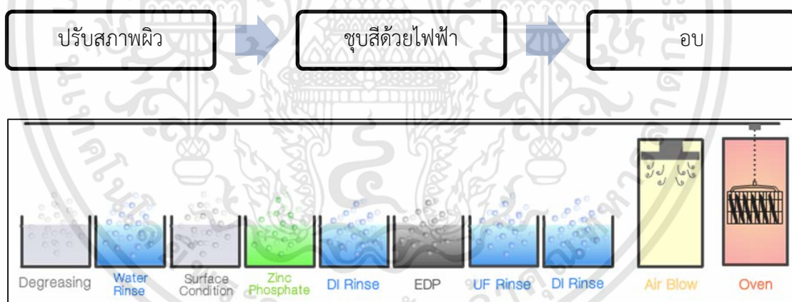
รูปที่ 2.2 กระบวนการชุบสีด้วยไฟฟ้า
