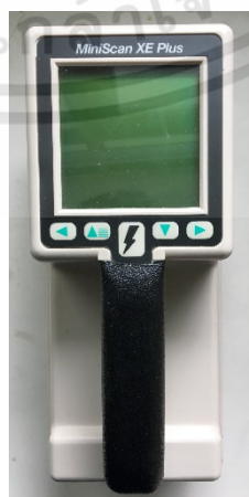
ภาพที่ 3.6 เครื่องวัดสี MiniScan XE Plus, Hunter Lab, USA
