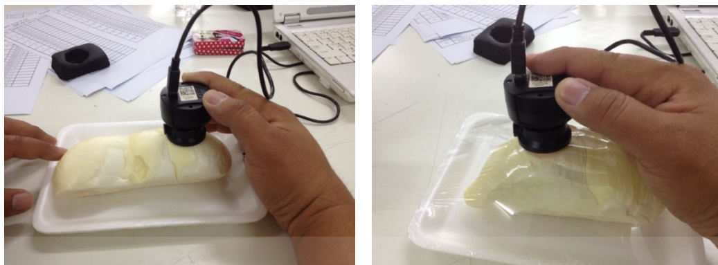
ภาพที่ 3.13 การสแกนด้วยเครื่อง Longwave linear variable filter spectrometer (MICRO NIR JDSU, USA)
