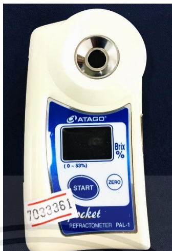
ภาพที่ 3.4 เครื่องวัดปริมาณของแข็งที่ละลายได้ (Brix Refractometer, ATAGO Pocket REFRACTOMETER PAL-1, Japan)
