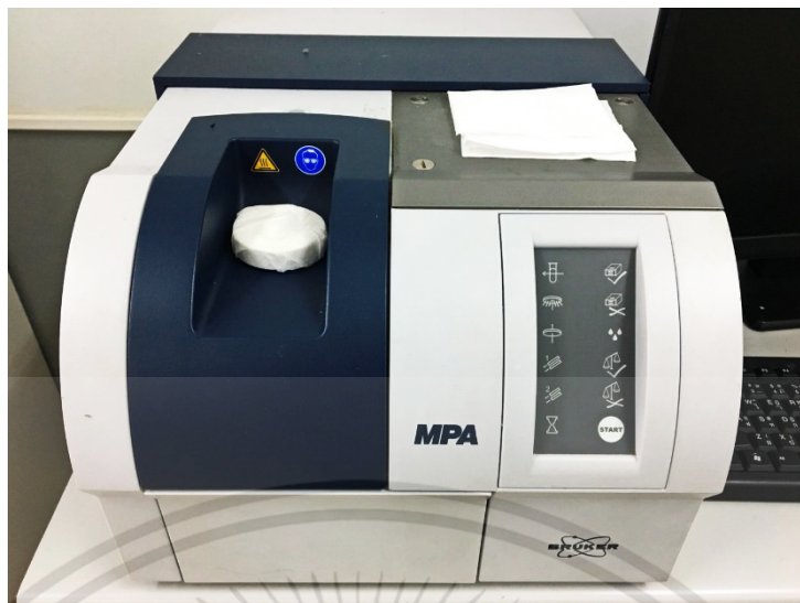
ภาพที่ 3.1 เครื่อง FT-NIR Spectrometer (MPA, Bruker Ltd., Germany)
