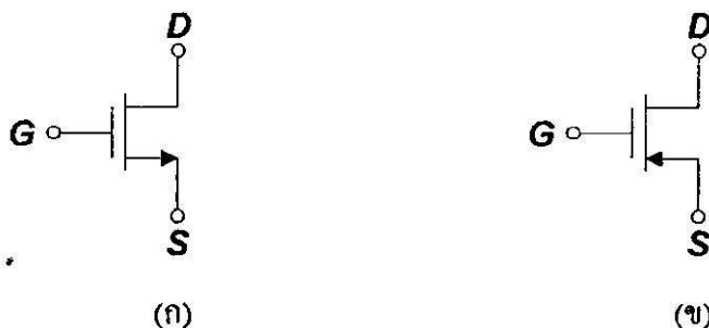
รูปที่ 2.1 สัญลักษณ์ของมอสทรานซิสเตอร์
