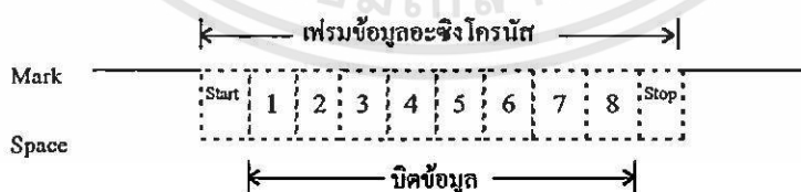
รูปที่ 3.13 เฟรมการส่งข้อมูลแบบอะซิงโครนัส
