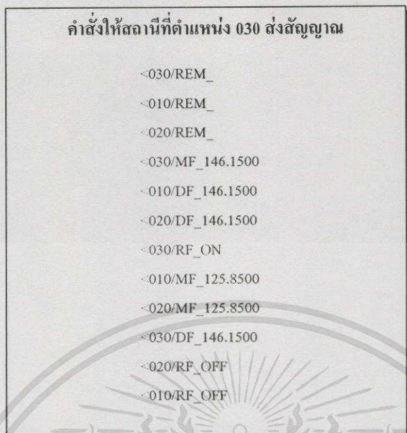
รูปที่ 4.47 การกำหนดพารามิเตอร์ในการเปลี่ยนสถานีส่ง
