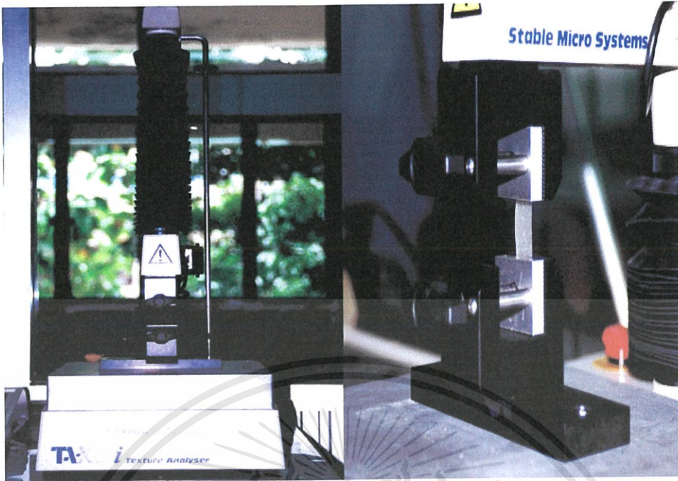
รูปที่ 3.4 เครื่องวัดความต้านทานแรงดึงขาดและความสามารถในการยืดตัว (Texture Analyser) TA – XT2, England
