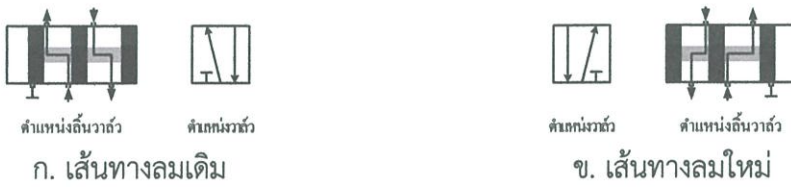
รูปที่ 2.47 สัญลักษณ์ตำแหน่งวาล์วของวาล์วควบคุมห้าทาง [13]
