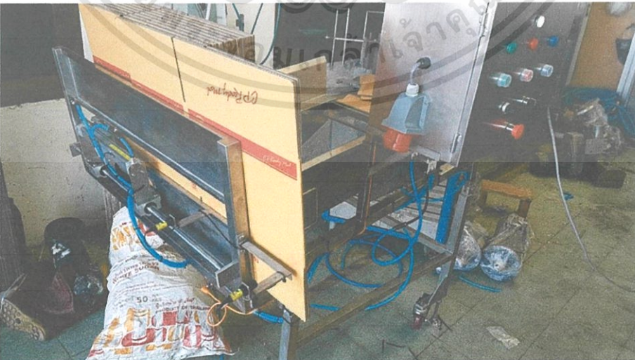
รูปที่ 4.4 เครื่องจักรทดสอบลำดับการทำงานป้อนกล่องกระดาษขนาดใหญ่ที่สุด
