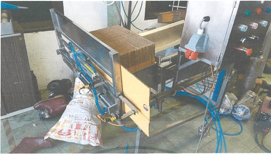
รูปที่ 4.2 เครื่องจักรทดสอบลำดับการทำงานป้อนกล่องกระดาษขนาดเล็กที่สุด
