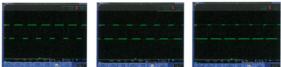
ภาพที่ 4.7 สัญญาณ PWM ที่ระดับความสว่าง 150 , 200 และ 240
