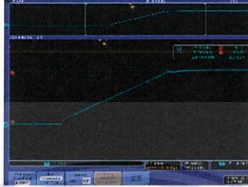
ภาพที่ 4.2 สัญญาณแรมป์ที่ power supply ทั่วไป
