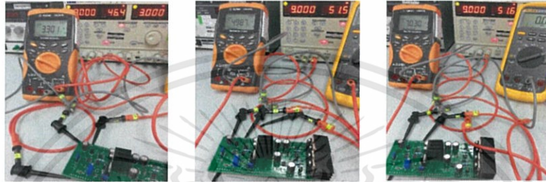
ภาพที่ 4.1 แรงดันเอาต์พุต 3.3V , 5V และ 0-7V
