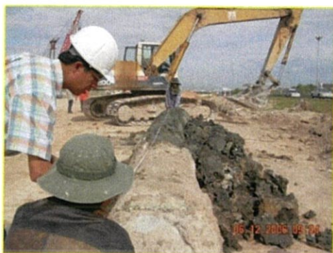
รูปที่ 2.45 การถอนเสาเข็มดินซีเมนต์ขึ้นมาวัดความยาวและผ่าตัวอย่างออก[2] -วัดขนาดเส้นผ่านศูนย์กลางและพิจารณาความสม่ำเสมอของเนื้อดินซีเมนต์ทั้งแนวยาว
