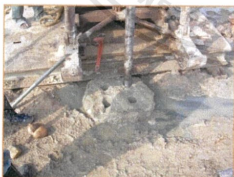
รูปที่ 2.47 การทดสอบแบบ 4 Holes Coring[2]
