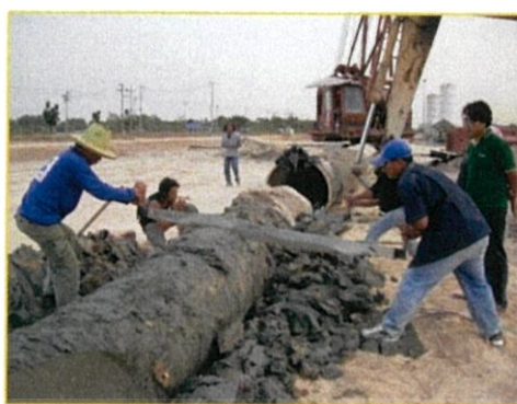
รูปที่ 2.45 การถอนเสาเข็มดินซีเมนต์ขึ้นมาวัดความยาวและผ่าตัวอย่างออก[2] -วัดขนาดเส้นผ่านศูนย์กลางและพิจารณาความสม่ำเสมอของเนื้อดินซีเมนต์ทั้งแนวยาว
