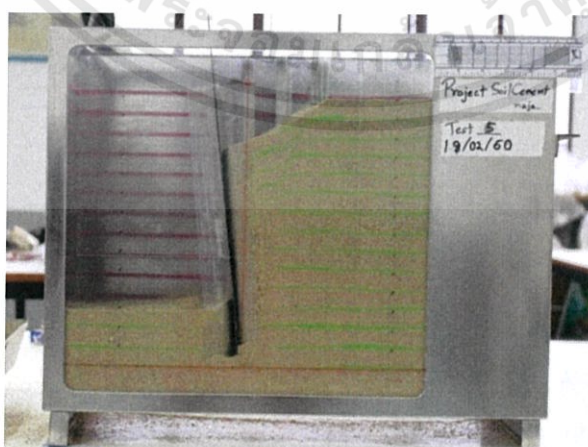
รูปที่ 4.11 แบบจำลองรูปแบบการติดตั้งเสาเข็มดินซีเมนต์ปักเว้นระยะทั้งทางด้านแรงดันดินเชิงรุกที่ ระยะการขุด 22 เซนติเมตร
