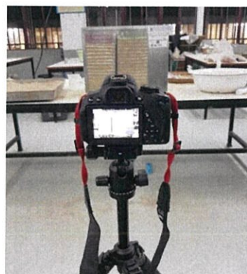
รูปที่ 3.37 ติดตั้งอุปกรณ์วัดการเคลื่อนตัว
