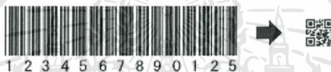
รูป 2.4 เปรียบเทียบกับบาร์โค้ดแบบธรรมดา กับ QR Code
