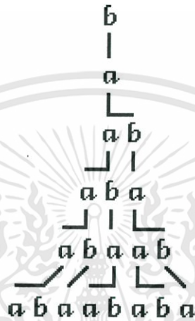
รูป 2.4 Axial tree ที่สร้างจาก ระบบกำหนดบริบทลินเดนเมเยอร์
