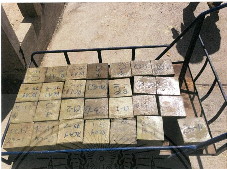
รูปที่ ก.3 คอนกรีตที่ผ่านการบ่ม ทำการตากแดดเพื่อให้แห้งแล้วนำไปทดสอบกำลังรับแรงอัด
