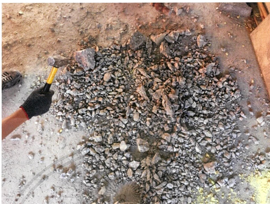
รูปที่ ก.1 วัสดุมวลรวมหยาบที่ได้จากการย่อยเศษคอนกรีต
