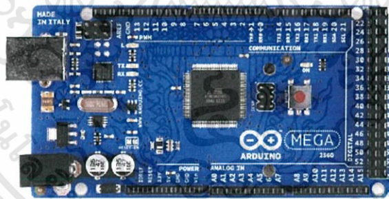
รูปที่ 2.1 ส่วนประกอบของ Arduino board รุ่น MEGA 2560 [1]
