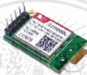
รูปที่ 3.15 GSM Module SIM800L [9]
