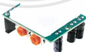
รูปที่ 3.16 PIR Motion Sensor Module [7]
