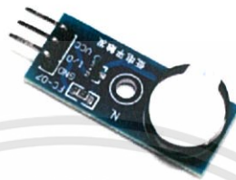
รูปที่ 3.13 Active Buzzer Module [1]
