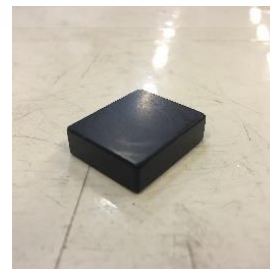
รูปที่ 2 แม่เหล็กถาวรชนิด Sintered Nd-Fe-B Grade 38UH
