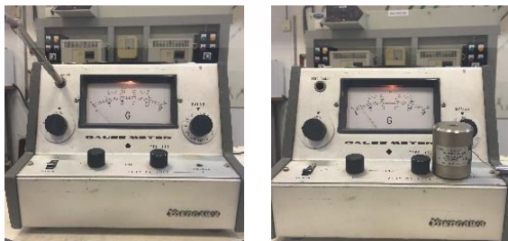
รูปที่ 5 (ซ้าย) การปรับตั้งศูนย์ (ขวา) การสอบเทียบแม่เหล็กมาตรฐาน 1000G
