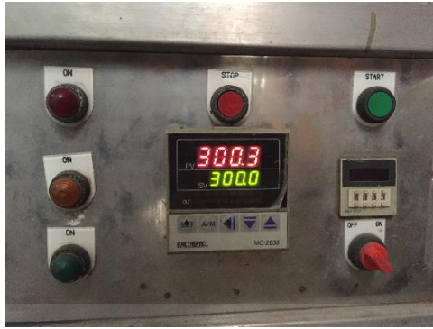
รูปที่ 3.12 ผลการสอบเทียบอุณหภูมิระหว่างเครื่องอบร้อนและเครื่องมือวัดอุณหภูมิมาตรฐานที่อุณหภูมิปรับตั้ง 300 องศาเซลเซียส
