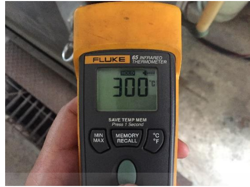
รูปที่ 3.12 ผลการสอบเทียบอุณหภูมิระหว่างเครื่องอบร้อนและเครื่องมือวัดอุณหภูมิมาตรฐานที่อุณหภูมิปรับตั้ง 300 องศาเซลเซียส
