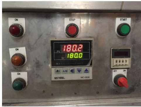
รูปที่ 3.9 ผลการสอบเทียบอุณหภูมิระหว่างเครื่องอบร้อนและเครื่องมือวัดอุณหภูมิมาตรฐานที่อุณหภูมิปรับตั้ง 180 องศาเซลเซียส
