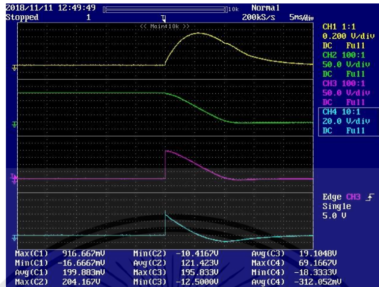
รูปที่ 4.11 ผลของการกระตุ้นขดลวดกระตุ้นรูปแบบที่ 2 ด้วยตัวเก็บประจุขนาด 470 มิลลิฟารัด ณ ระดับแรงดัน 200 โวลต์ โดยกระแสกระตุ้นสูงสุดที่เกิดขึ้น คือ 9,166.67 แอมป์แปร์ และแรงดันเหนี่ยวนำสูงสุดที่วัดได้ คือ 69.1667 โวลต์
