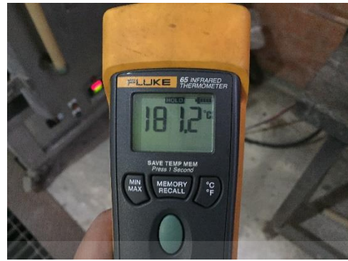
รูปที่ 3.9 ผลการสอบเทียบอุณหภูมิระหว่างเครื่องอบร้อนและเครื่องมือวัดอุณหภูมิมาตรฐานที่อุณหภูมิปรับตั้ง 180 องศาเซลเซียส
