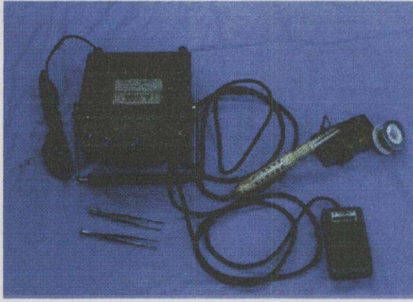
รูปที่ 3.8 ชุดบดกรี้อัตราโซนิกและตะกั่วที่มีจุดหลอมเหลวต่ำผสมอินเดียม
