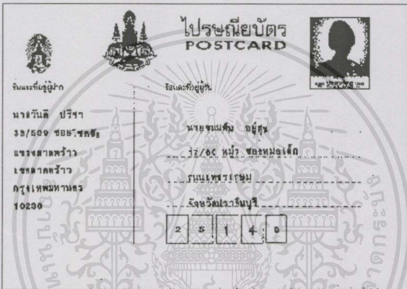
รูปที่ 7.56 แสดงไปรษณียบัตรที่นำมาทดสอบแล้วไม่สามารถอ่านรหัสไปรษณีย์ได้เนื่องจากเขียนรหัสไปรษณีย์ขนาดเล็กเกินไป
