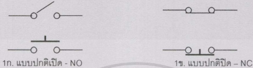
ภาพที่ 1 สัญลักษณ์ของสวิตช์เบื้องต้นแบบขั้วเดียวทางเดียว(SPST)
