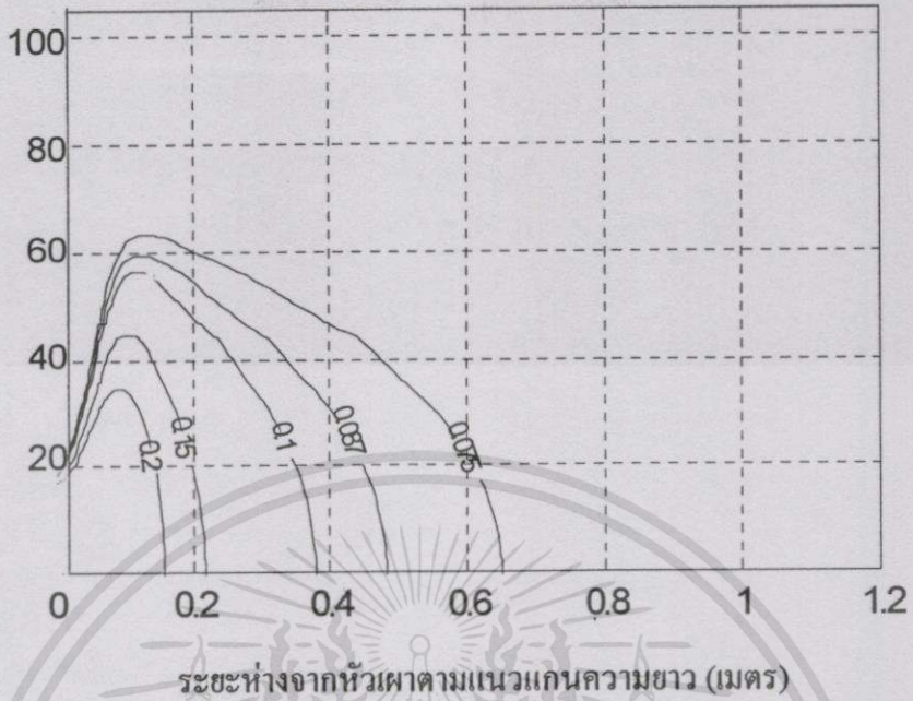
รูปที่ 5.27 การกระจายตัวของค่า f จากผลการทำนายที่สภาวะการหมุนของอากาศที่มุมเท่ากับ 45^\circ และการกระจายความเร็วที่ทางเข้าเป็นแบบไม่สม่ำเสมอ
