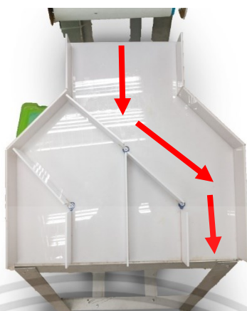
รูปที่ 5.10 การทำงานของแผ่นกั้นกรณีกลุ่ม D
