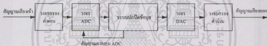
รูปที่ 3.8 ผังวงจรการเชื่อมต่อภายนอก เพื่อทดสอบการปิดข้อมูลเสียง
