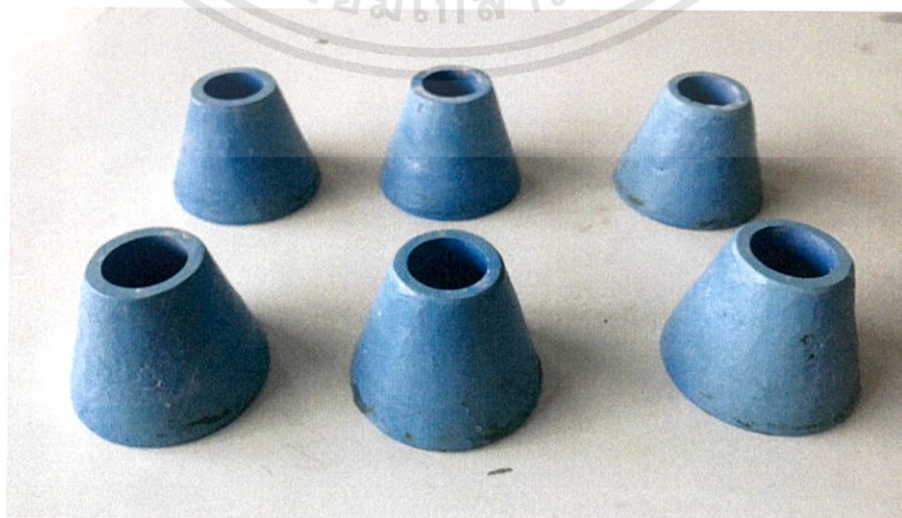
รูปที่ 3.26 กรวยทดสอบเวลาเซตตัวของสารซีเมนต์เบนโทไนท์ที่พัฒนาขึ้นมา
