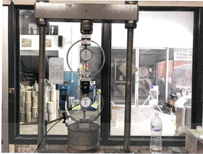
รูปที่ 4.25 การทดสอบเทียบ Proving ring No.15416 กับ No.15417
