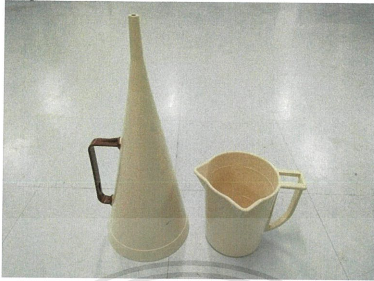
รูปที่ 3.1 รูปแสดงเครื่องมือ Marsh funnel viscometer
