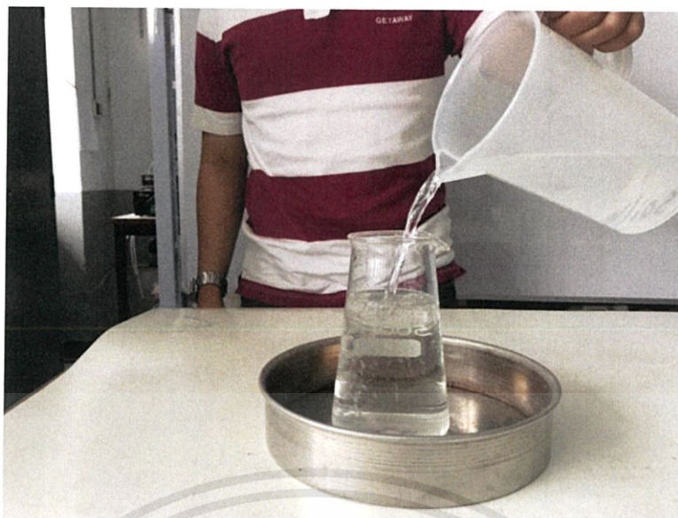
รูปที่ 3.14 นำปีกเกอร์วางลงในถาดรองน้ำ
