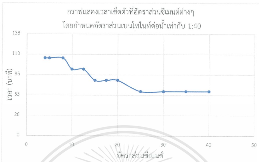
รูปที่ 4.12 กราฟแสดงเวลาเซตตัวของซีเมนต์เบนโทไนท์ที่การกำหนดค่าเบนโทไนท์ต่อน้ำเท่ากับ 1:40 โดยกำหนดให้มีการเปลี่ยนแปลงอัตราส่วนซีเมนต์
