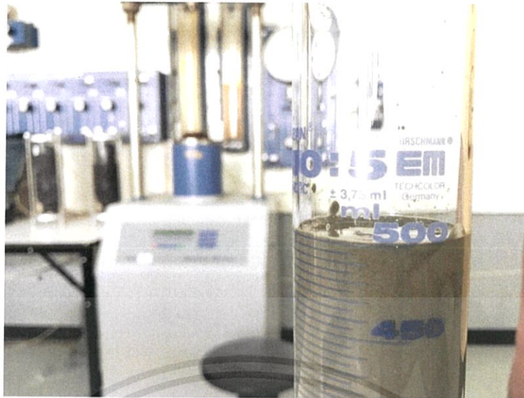
รูปที่ 3.11 ซีเมนต์เบนโทไนท์ที่ซีดบอกรปริมาณ 500 มิลลิลิตร
