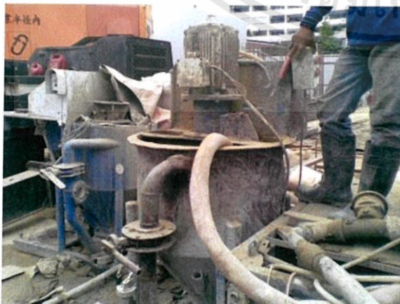
รูปที่ 2.8 แสดงเครื่องผสม Cement Bentonite (HIROSE,2559)
