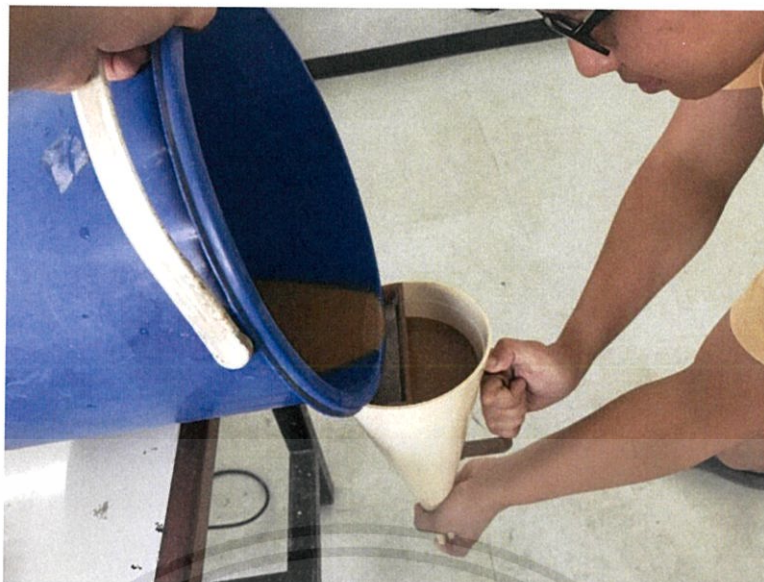
รูปที่ 3.5 เทสารตัวอย่างที่จะทดสอบความหนืดลงในกรวยให้ถึงขีดบอกระดับ
