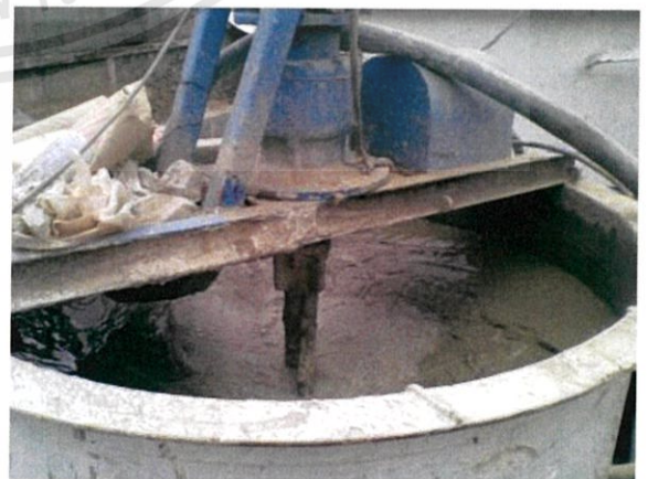
รูปที่ 2.8 แสดงเครื่องผสม Cement Bentonite (HIROSE,2559)
