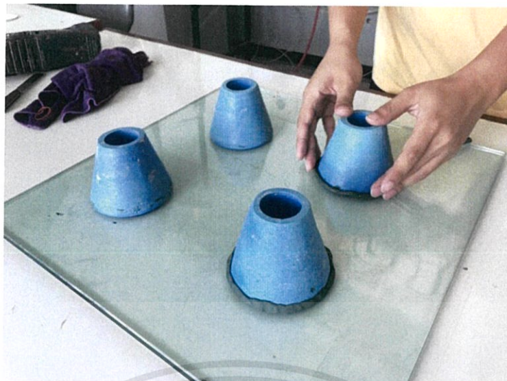
รูปที่ 3.29 การเตรียมกรวยทดสอบ
