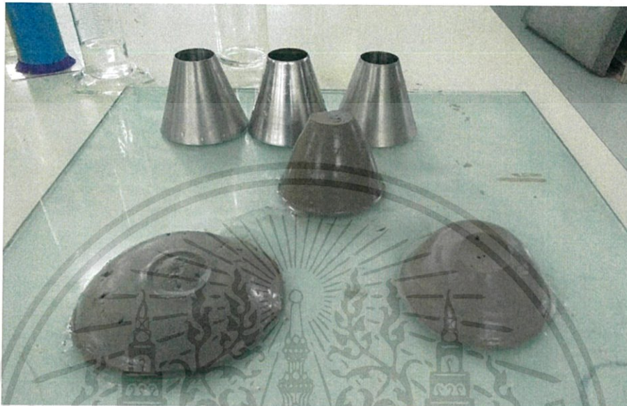
รูปที่ 3.25 รูปแสดงการยู่ตัวของซีเมนต์เบนโทไนท์ที่เวลา 1 ชั่วโมง 2 ชั่วโมง และ 3 ชั่วโมง
