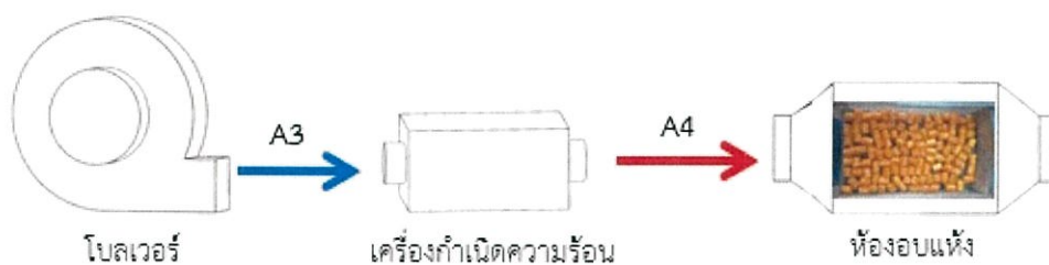
รูปที่ 3.10 แผนภาพการทำงานของส่วนประกอบในระบบอบแห้งแบบลมร้อนไม่ร่วมกับวงล้อดูดความชื้น
