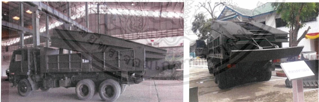
รูปที่ 1.1 รถวางสะพาน (Vehicle Launched Bridge)
