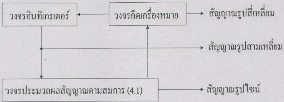
รูปที่ 4.2 บล็อกไดอะแกรมของวงจรผลผลิตสัญญาณรูปแบบที่ 1
