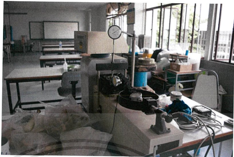
รูป 3.5 การทดสอบDirect Shearเพื่อหามุมเสียดทานภายใน
