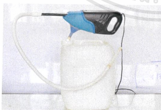
รูป 3.25 อุปกรณ์จำลองการขุดดิน
