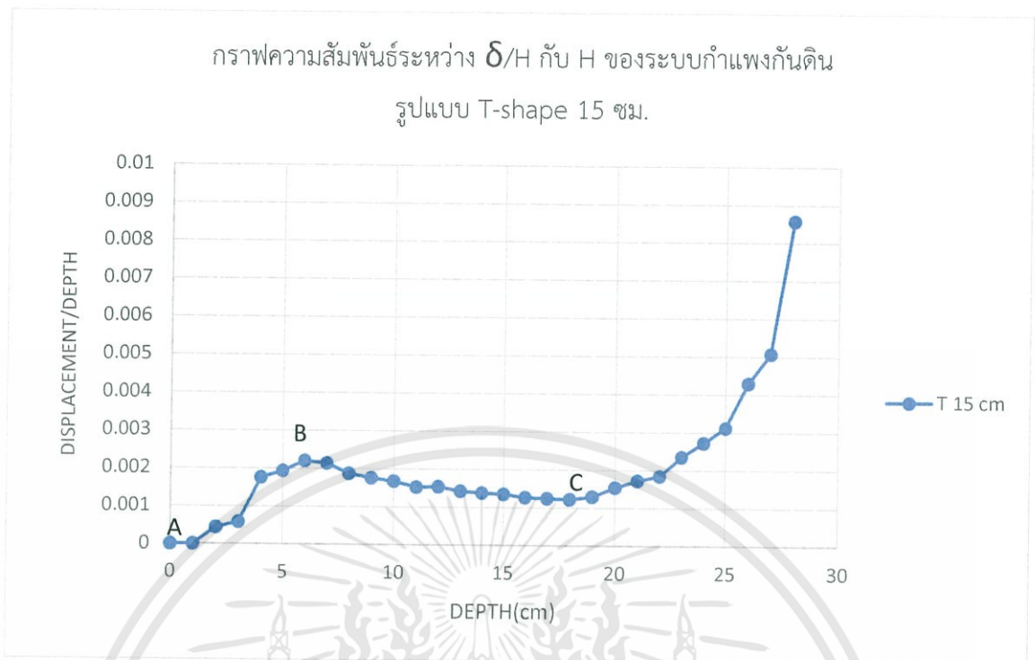
รูป 4.28 กราฟความสัมพันธ์ระหว่างอัตราส่วน \frac{\delta}{H} กับ H ของระบบกำแพงกันดิน รูปแบบ T-shape (ความยาวแกน 15 เซนติเมตร)
