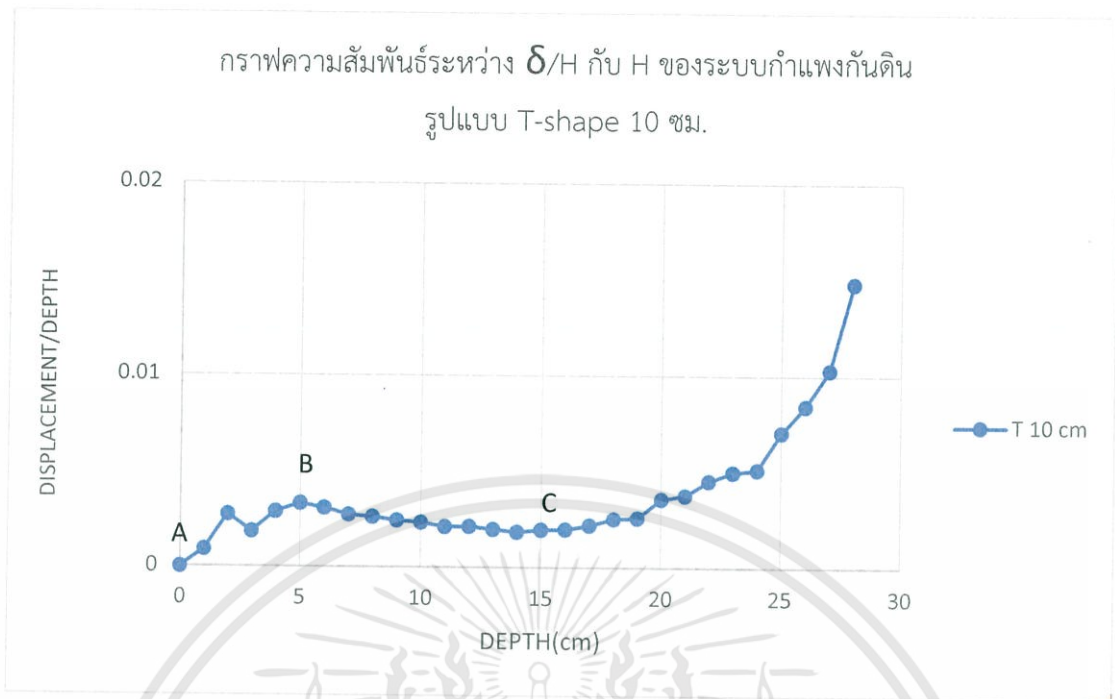
รูป 4.30 กราฟความสัมพันธ์ระหว่างอัตราส่วน \frac{\delta}{H} กับ H ของระบบกำแพงกันดิน รูปแบบ T-shape (ความยาวแกน 10 เซนติเมตร)
