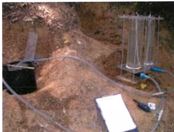
ข) การวัดค่าความชื้นน้ำของดินโดยใช้ Double ring
