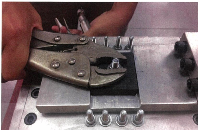
รูปที่ 3.25 การติดตั้งชิ้นงานที่จะทดสอบ
